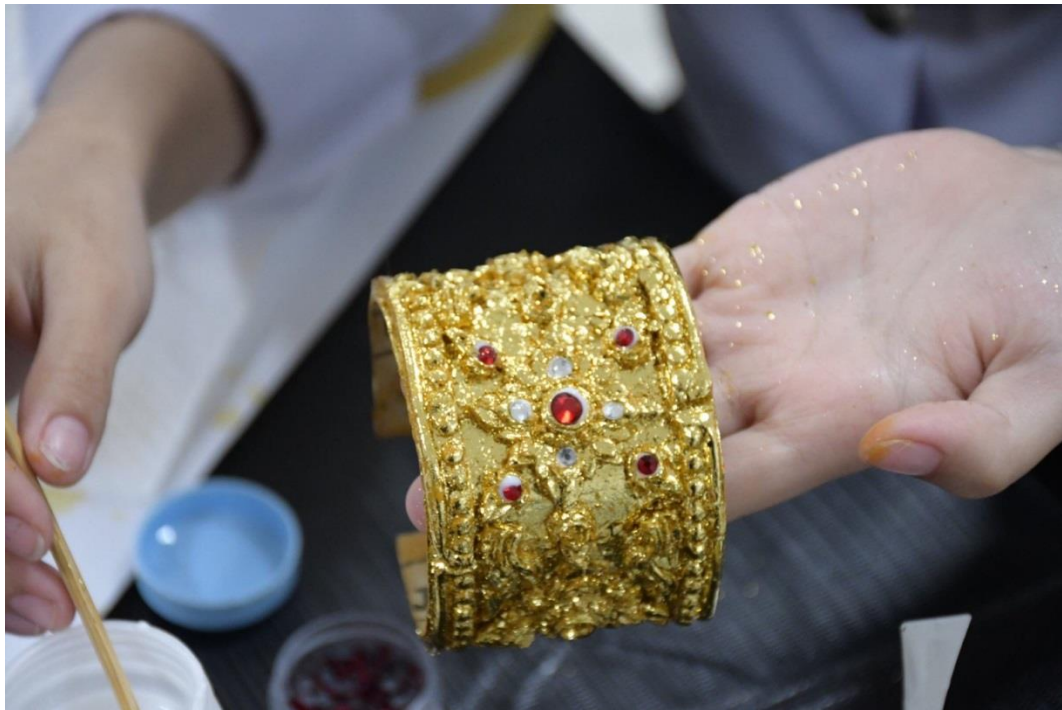
หลังจากแผ่นทองฝังตัวปะเก็นเรียบร้อยแล้ว นำเพชรมาติดตกแต่งตามลวดลาย
