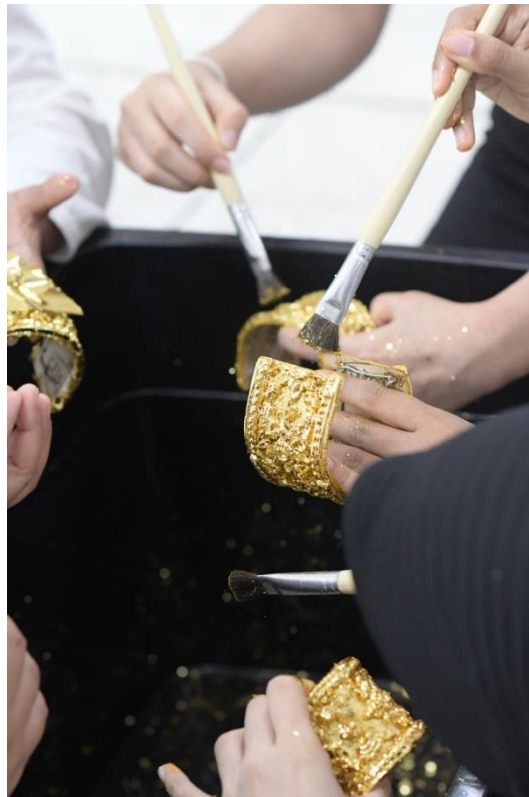
ลงแผ่นทองบนปะเก็นหลาย ๆ ชั้น ใช้แปรงกดลงตามลวดลาย และปัดส่วนเกิดออกเพื่อให้ลายชัดเจนยิ่งขึ้น
